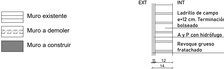
Detalle de muro ext-int a construir ESC. 1.15
